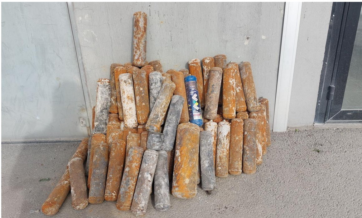
Bouteilles de protoxyde d'azote retrouvées dans le flux de déchets occasionnant des explosions dans le four.
